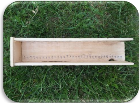
Photographie 3: boîtier en bois permettant de mesurer et photographier les individus.
