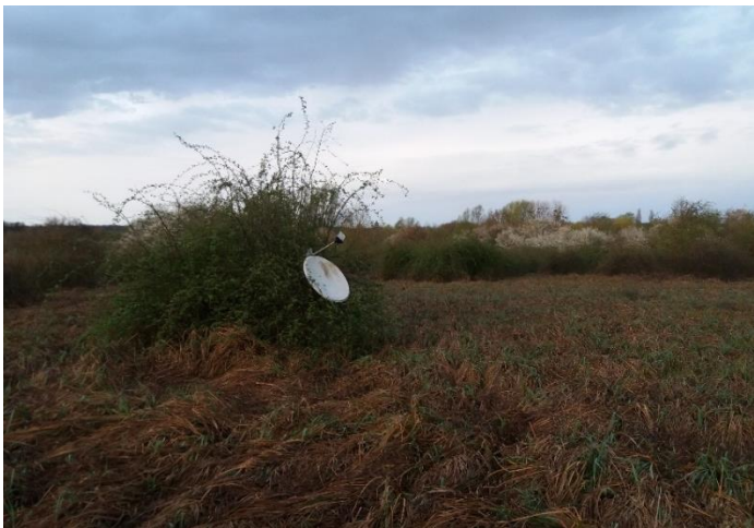
Système d'enregistrement nocturne composé d'une parabole tv avec en son point focal des micros reliés à un enregistreur numérique.
