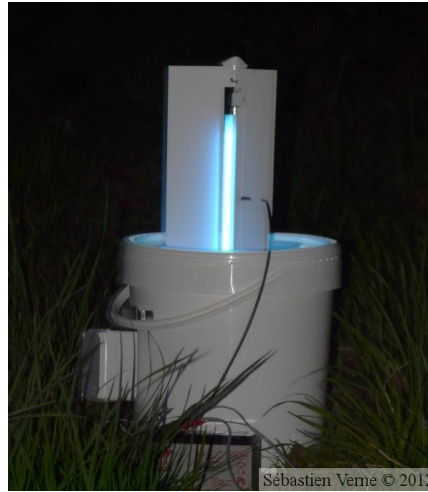
Piège de Heath, avec tube actinique 8W, source: http://www.sebastien-verne.fr
